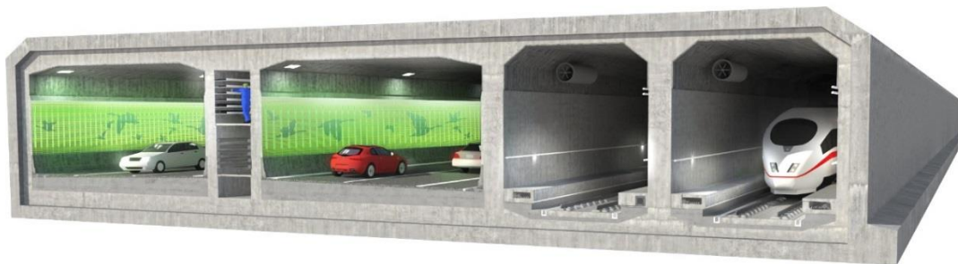
Standardelement til sænketunnelen
